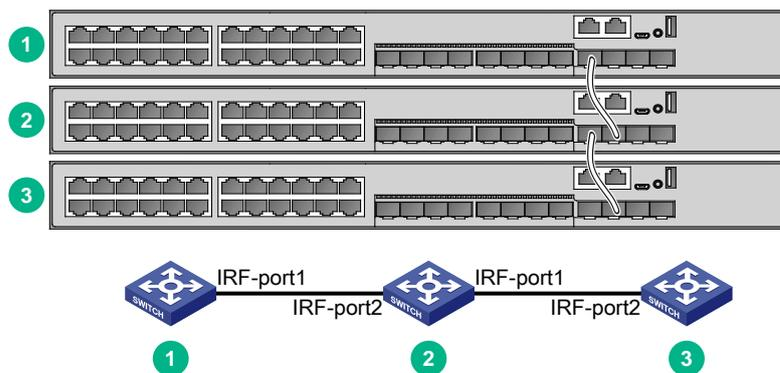
图5-3 IRF 环型连接方式及对应的拓扑示意图
