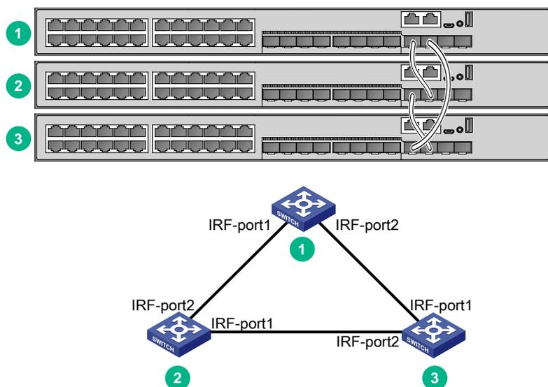
S5600X-EI 系列交换机能够通过多种类型的接口提供 10GE/40GE 速率的 IRF 物理连接，具体请参见表 5-2。您可以通过将多个 IRF 物理端口与一个 IRF 端口绑定的方式，来实现成员设备间的聚合 IRF 连接。聚合 IRF 连接可以提供更高的性能和可靠性，您可以根据实际需要进行选择。
