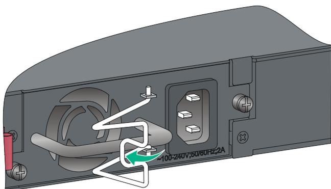
图3-17 PSR150-A1 交流电源线连接示意图（二）
