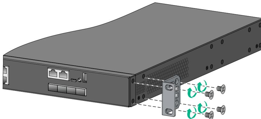
图3-5 安装挂耳到设备电源侧的示意图
