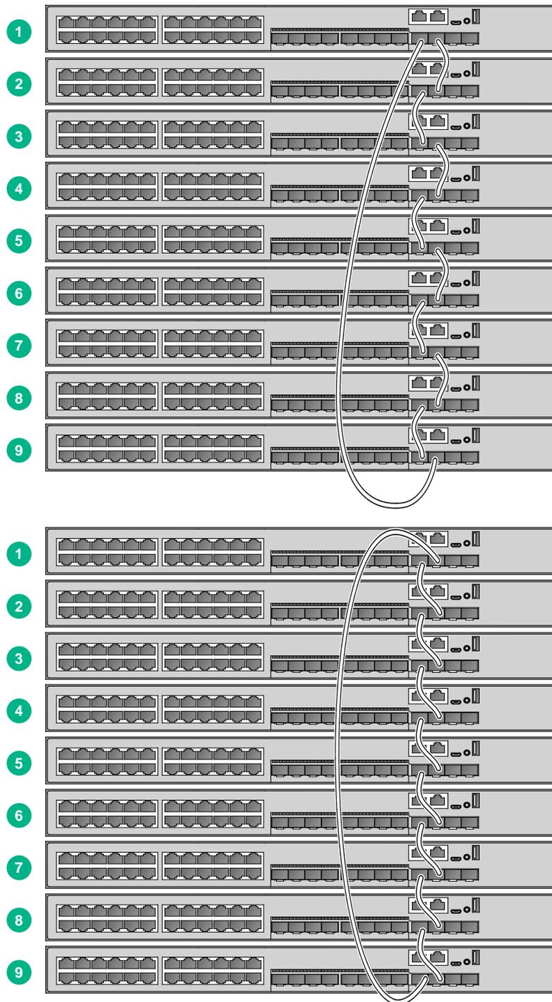
上述连接方式对应的是比较直观的环形拓扑，便于后期维护。拓扑连接关系如[图 5-5](#)所示。
