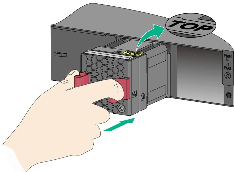
交换机初次上电时，还需要在交换机上使用 `fan prefer-direction` 命令配置设备的期望风道风向与所选风扇风向一致，否则系统会输出 Trap 和 Log 信息进行告警。缺省情况下，交换机的期望风道风向与 LSPM1FANSA-Z 风扇风向一致，即电源侧进风、端口侧出风。有关 `fan prefer-direction` 命令的详细介绍请参见交换机配套配置指导和命令参考。
